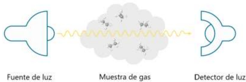
Figura 2. Esquema de la absorción de luz IR causada por moléculas que pasan a un estado excitado.
