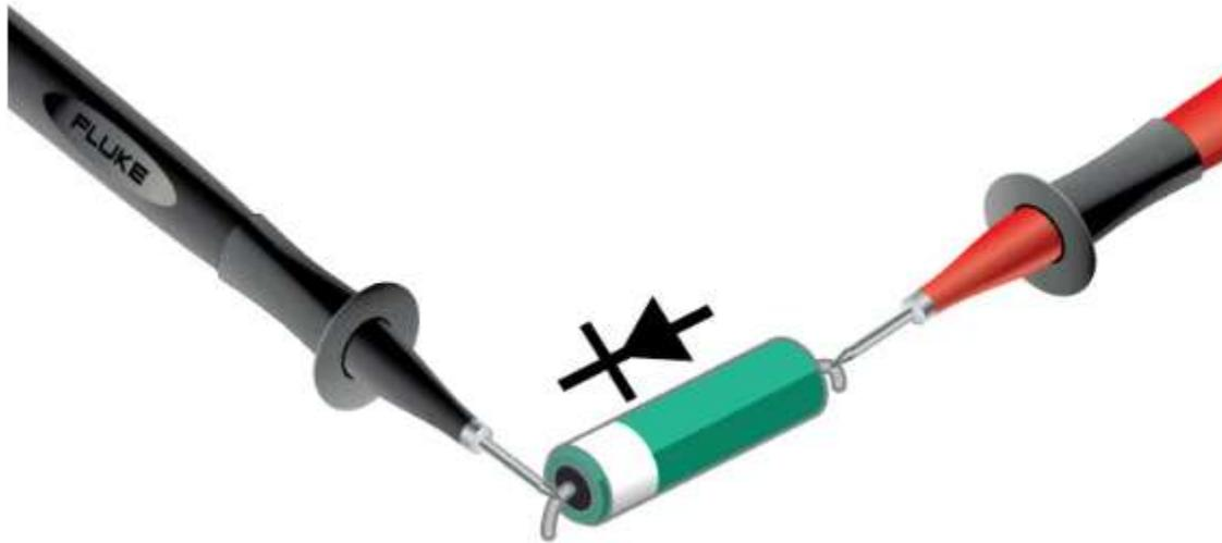
Un diodo es un dispositivo semiconductor que actúa esencialmente como un interruptor unidireccional para la corriente. Permite que la corriente fluya en una dirección, pero no permite a la corriente fluir en la dirección opuesta.
