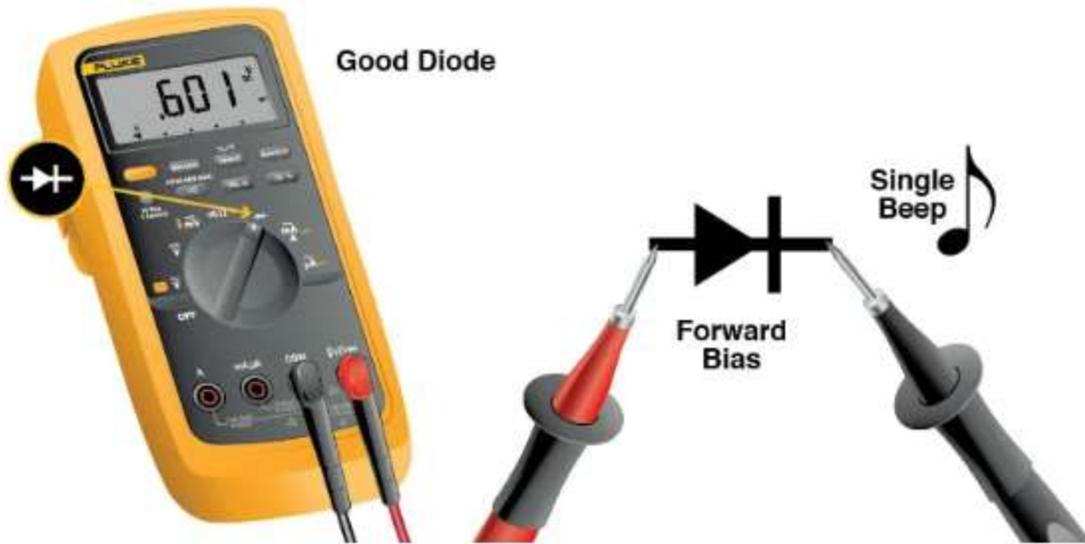
Se asignan capacidades de corriente a los diodos. Si se supera la capacidad y el diodo falla, puede producirse un cortocircuito y a) permitir que la corriente fluya en ambos sentidos o b) interrumpir el flujo de corriente en los dos sentidos.
