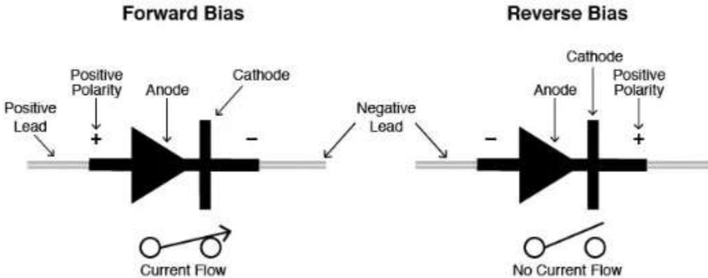
El modo de prueba de diodos de un multímetro digital produce un pequeño voltaje entre las puntas de prueba suficiente para aplicar polarización directa a la juntura de un diodo. La caída de tensión normal es de 0.5 V a 0.8 V. La resistencia de un diodo en buen estado con polarización directa debe variar de 1000 ohmios a 10 ohmios. Cuando se aplica polarización inversa, la pantalla de un DMM muestra OL (que indica resistencia muy alta).
