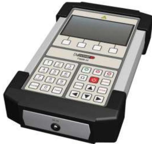
La relación de transformación es determinada aplicando un voltaje CA a través del bobinado de alta tensión y midiendo con precisión en el correspondiente enrollado del lado de baja y mostrando la relación entre ambos voltajes.
