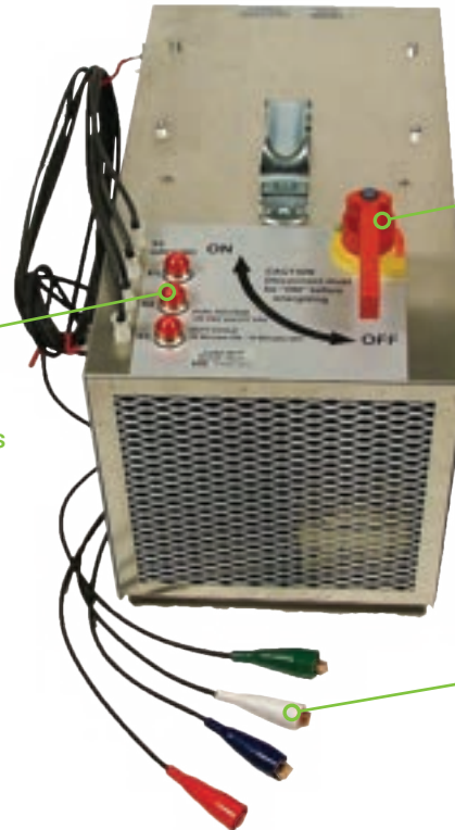
Lámparas indicadoras de fusibles fundidos
