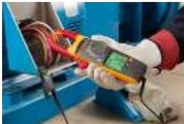
La pinza amperimétrica 378 FC de Fluke mide A CA y V CA.
