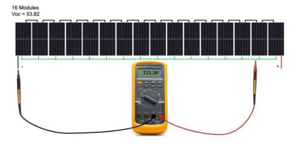
Esperábamos cero voltios a tierra. Sin embargo, las mediciones indicaron tensión a tierra tanto en el lado positivo como en el negativo del circuito de la cadena fotovoltaica. Podemos dividir ambas lecturas a tierra por el módulo individual Voc para identificar la ubicación de la falla a tierra.
