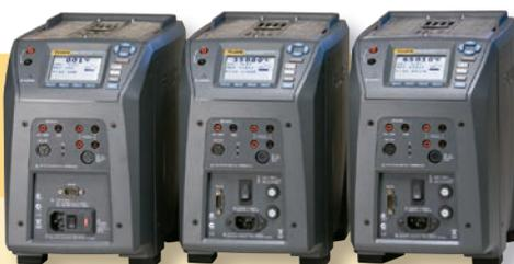
**Pozo seco de doble bloque industrial 9009 de Fluke Calibration**
