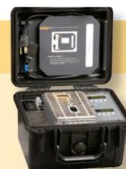
**Calibradores de pozos secos para uso en terreno 9103/9140 de Fluke Calibration**
