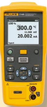
**Calibrador de termopares 714B de Fluke**
