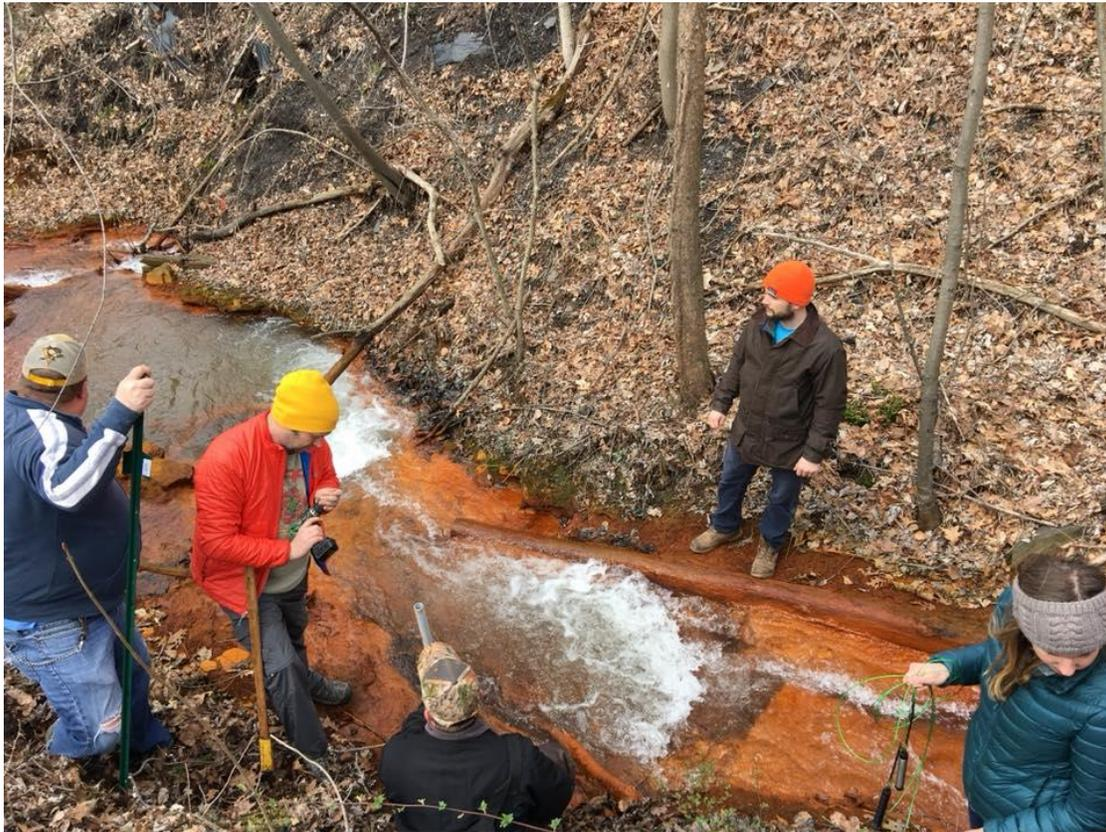
*Instalación de Leveloggers para medir el nivel del agua en la descarga de una mina abandonada*
