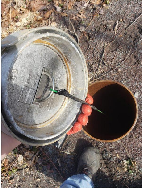
*Instalaciones de Levelogger con cable en pozo tranquilizador y pozo*
