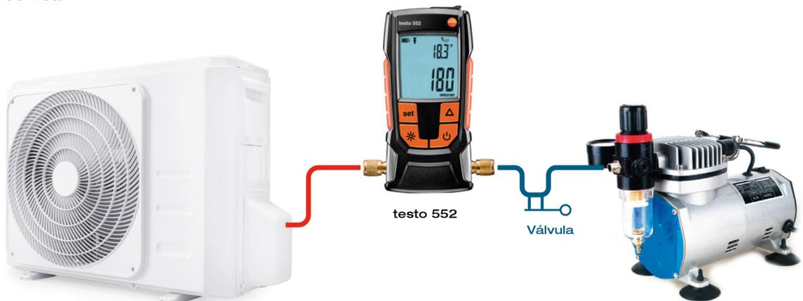
**Figura 4.** Una mejor opción: reemplazo de la manguera por una válvula de grado vacío y un acople para vacuómetro.
