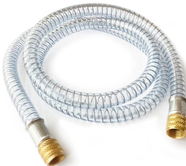
**Figura 1.** La utilización de mangueras adecuadas, de mayor sección, menor longitud y barrera impermeable es fundamental para poder alcanzar buenos niveles de vacío.
