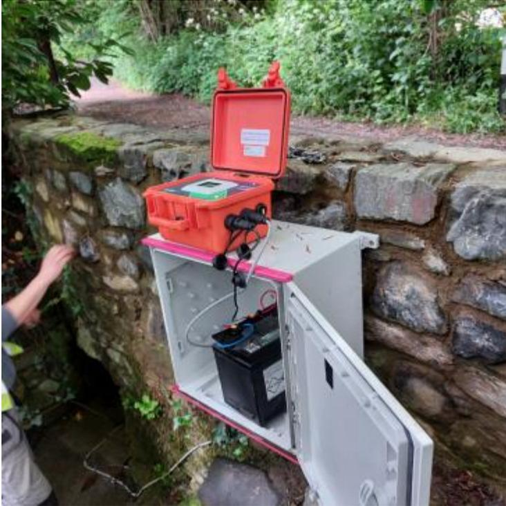
El funcionamiento con batería ha demostrado ser un éxito para la cantera, debido a la ubicación remota del punto de medición, permitiendo que la unidad pueda recopilar los datos de flujo requeridos para el permiso de expansión. El tamaño compacto de la unidad también ha significaba que podía instalarse discretamente en un gabinete al costado de un pequeño puente. Ahora, precisos datos de flujo están siendo y registrados; Se requieren 3 años de datos para la expansión permiso que se conceda.
