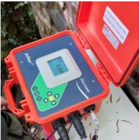
*“Este es un gran ejemplo de cómo se puede usar MantaRay para el flujo normal en el campo. Es robusto, portátil y alimentado por batería. El registro integral puede registrar con precisión la medición del flujo en intervalos preseleccionados, brindando la solución perfecta para recolectar datos para cualquier encuesta o requisitos de medición a largo plazo.”*
