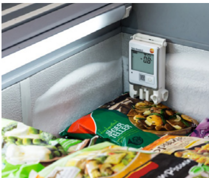
Supervisión en congeladores
