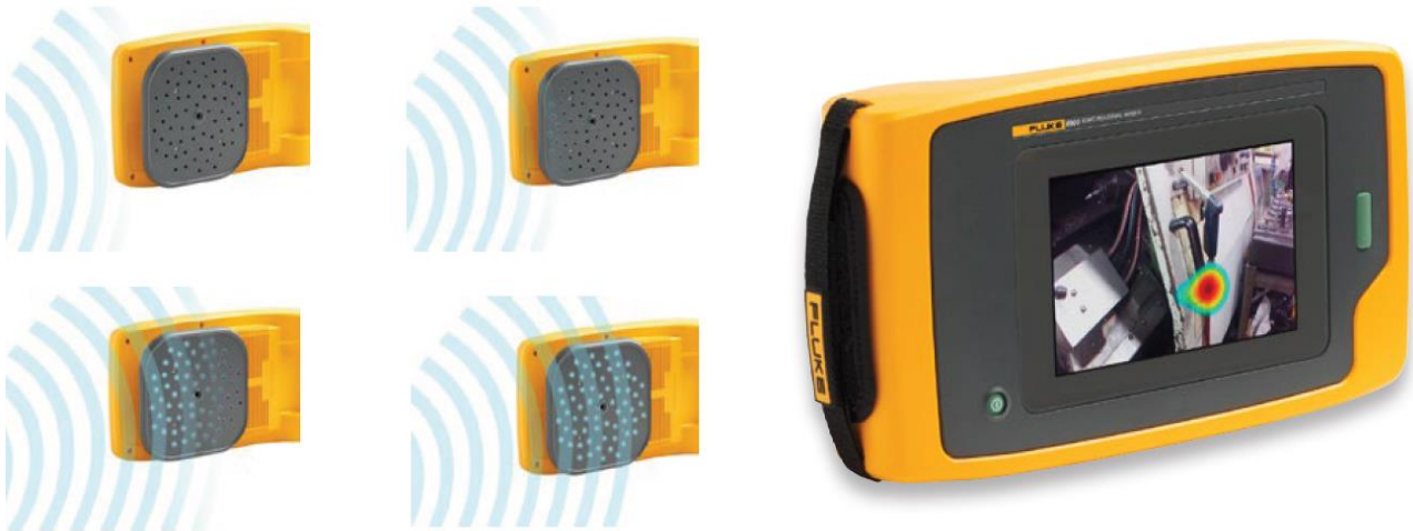
Figura 1: Esta figura ilustra de manera muy simplificada el principio de operación de la cámara acústica Fluke ii910: la matriz de 64 micrófonos de alta sensibilidad y gran rango de frecuencias (2kHz a 100 kHz) permite localizar las fuentes de emisión acústica gracias a algoritmos complejos que muestran la información en forma gráfica superponiendo la información acústica a la imagen capturada por una cámara visible, en tiempo real.
