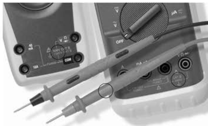
Verifique la categoría y la tensión nominal de las puntas de prueba y los multímetros.
