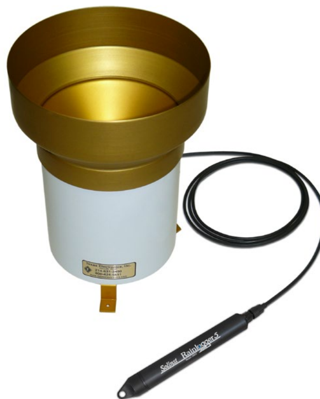
Figura 10-21 Rainlogger 5 conectado al balancín
