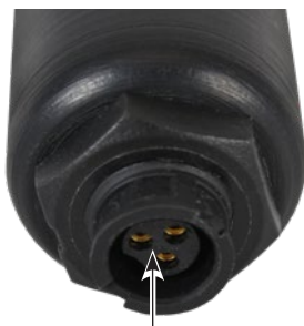
Conector del pluviómetro
