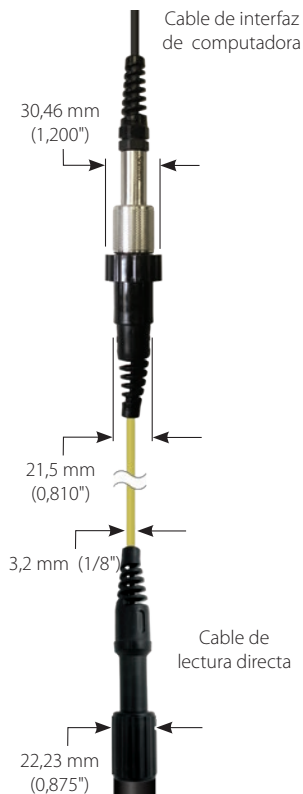
Figura 10-8 Dimensiones del cable de lectura directa del modelo L5
