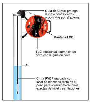
La unidad se suministra con la guía de cinta para utilizarla cuando se esta perfilando. La guía permite hacer la medición del nivel del agua utilizando la marcación que tiene en su centro lo cual proporciona mediciones de nivel exactas y repetitivas. La guía protege la cinta contra daños producidos por los bordes de los ademes.
